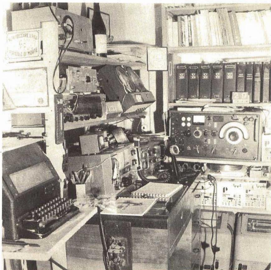
Fig. 5 - Più disordinata ma completa è questa stazione di Gloriano Rossi 12KH di Milano. Disposto alla buona, c'è tutto; dai trasmettitori a due o tre ricevitori ed altrettante telescriventi. Sul ripiano del tavolo è disposto il «Log» o Libro di Stazione sul quale debbono venire annotate sistematicamente tutte le comunicazioni effettuate. Non manca neppure una bottiglia a testimoniare che gli «OM» sono buone forchette che amano la vita e la buona compagnia.
